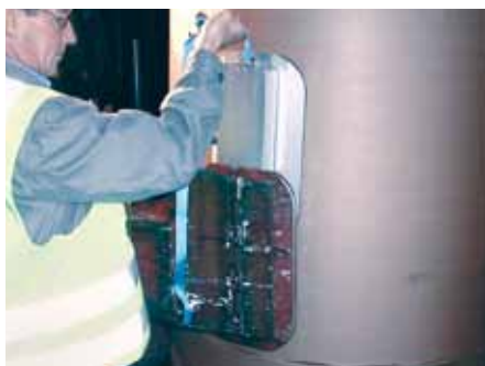
Durch die schlanke Bauform paßt sich die Test-Kontaktplatte unterschiedlichen Rollendurchmessern bestens an.
