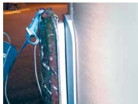
Die Test-Kontaktplatte wird zwischen der Papierrolle und der Kontaktplatte der Papierrollenklammer plaziert und mißt die Klammerkraft.
